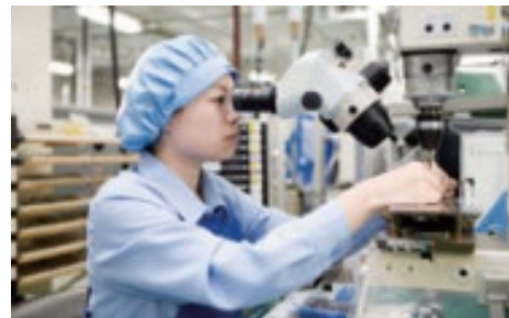
スコープ部品の精密組立作業
