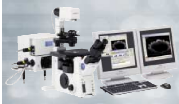
<共焦点レーザー走査型顕微鏡 FLUOVIEW FV1000> 世界初、ツインスキャンシステムを搭載。生きた細胞へレーザーによる光刺激とその反応の同時観察が可能に。
