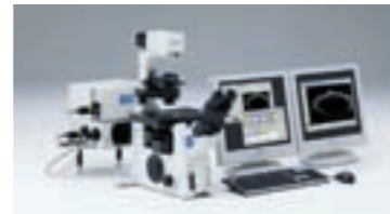
共焦点レーザー走査型顕微鏡 「FLUOVIEW FV1000」 ツインスキャンシステムを搭載することで、生きた細胞へのレーザーによる光刺激とその反応の同時観察を可能に
