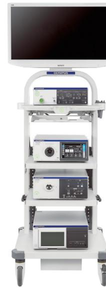
4K技術を搭載した外科手術用内視鏡システムです。従来のフルハイビジョン映像に比べて、画素数が約4倍になり、高精細な映像での手術が可能となりました。また、豊富な色再現性により、微細組織(血管、神経、リンパ管など)の容易な識別をサポートします。
