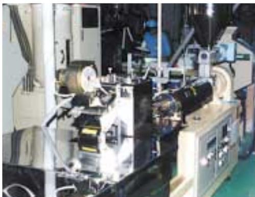
■プラスチック端材ペレット化装置
