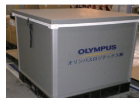
段積を可能にした通い函「ワコボン」(改善後)
