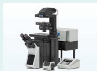
生物用共焦点レーザー走査型顕微鏡
