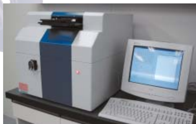
ドイツのエポテック社と共同開発した一分子蛍光分析技術を取り入れたSNP(一塩基多型)解析装置
