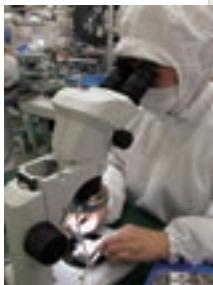
▲処置具製品の精密組立作業
