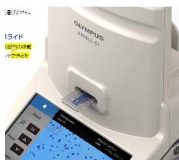
本体中央の挿入口に専用スライドをセット
