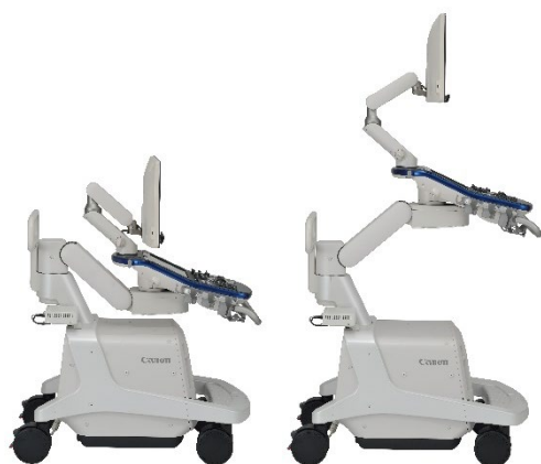
左：ユーザーニーズに合わせて高さ調整可能 右：操作パネル/タッチパネル正面図
